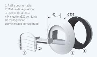
• Para el montaje de los ALIZE AUTO 120 y 150 en el manguito ø99, utilice el espaciador para la adaptación al manguito ø99 (código 1941)
