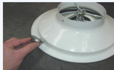
**3.** Realice en la parte final del cuello del difusor (junto al radio de conexión) un agujero pasante (Ø 5,5 mm) para la fijación del cable de acero de seguridad (D).
