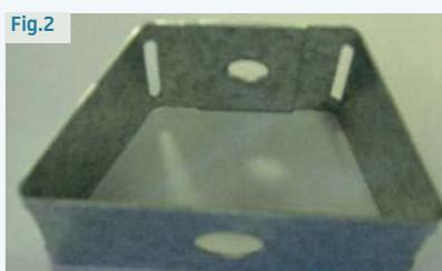
**5.** Doblando manualmente las ranuras del colgador a lo largo de la C y la D (Fig. 1). Debe obtener el formato de la figura 2. Asegúrese de que los agujeros F se encuentran en la misma posición para poner el elemento de fijación (Fig. 2).
